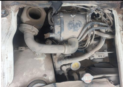
4-rasm. Ikki bosqichli havo tozalagich ishlashining sxemasi.
