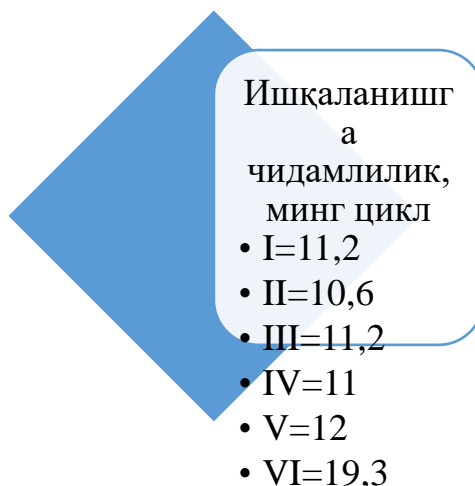
Рисунок 4. Показатели стойкости к истиранию двухслойных трикотажных полотен новой структуры.
